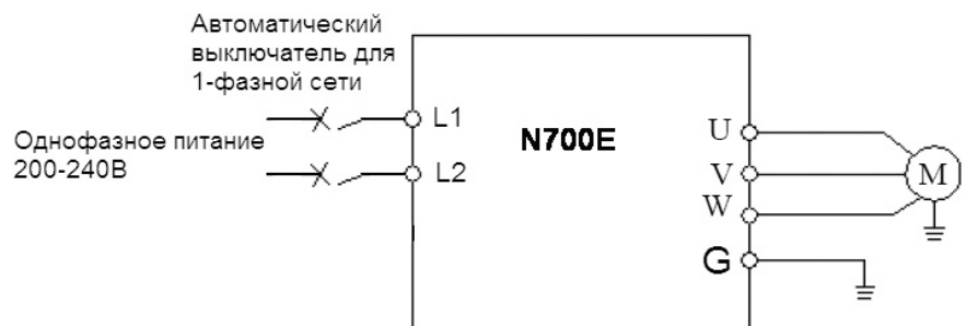
Рисунок 2. Однофазная схема подключения мотора к ЧП
